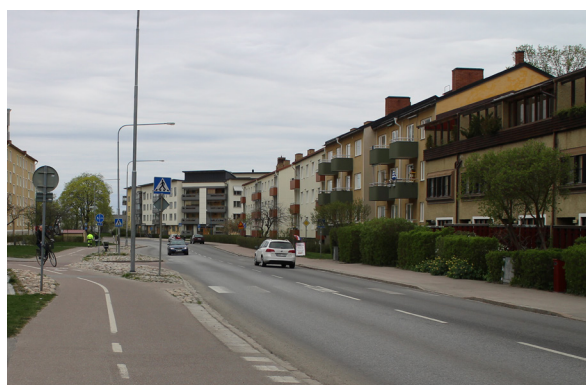
Figur 12. Passage över Börjegatan vid Prästgårdsgatan. Vy åt nordväst. Ingen fysisk hastighetsbegränsning och skyltat hastighet 50 km/h ger låg trafiksäkerhetsbedömning.
